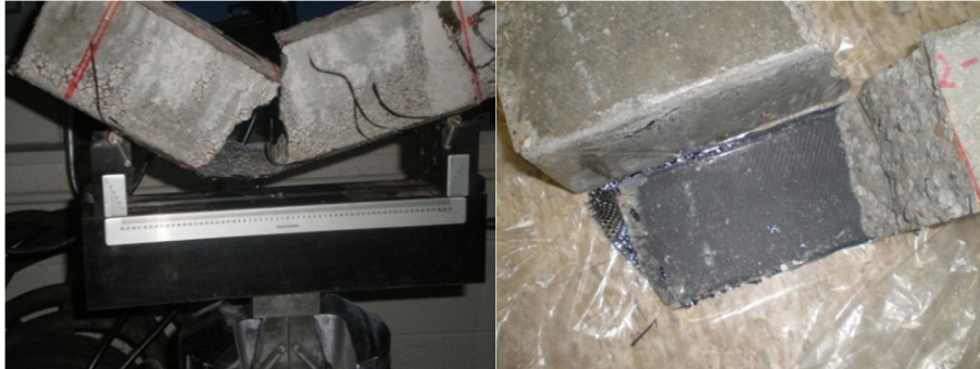
(أ) أنهيار الإحناء بالكمرة الخرسانية B1 (ب) إنفصال طبقة ألياف الكربون عن سطح الخرسانة بالكمرة B1 Concrete flexural crack, (beam B1) FRP delamination on concrete surface, beam B1
