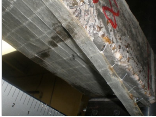
شكل (12) تمزق ألياف البوليمر إلى شرائح عند الإنهيار، B8 FRP Strips rip at the time of failure, B8
