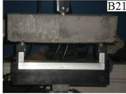
شكل (6) اختبار مقاومة الأنحاء للكمرة B21 (عينة مرجعية) Flexural strength test, B5 "Control Specimen"
