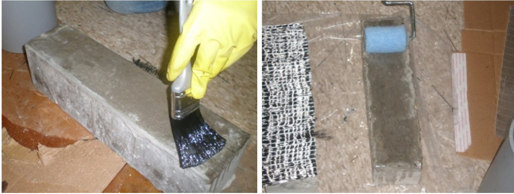
شكل (5) وضع الأيبوكسي على سطح الكمرة الخرسانية
