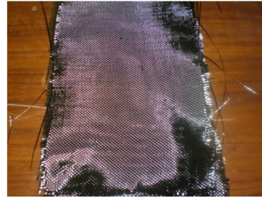
شكل (1) ألياف الكربون ثنائي الإتجاه ( SikaWrap Hex 113 Bi-directional (0°/90°)
