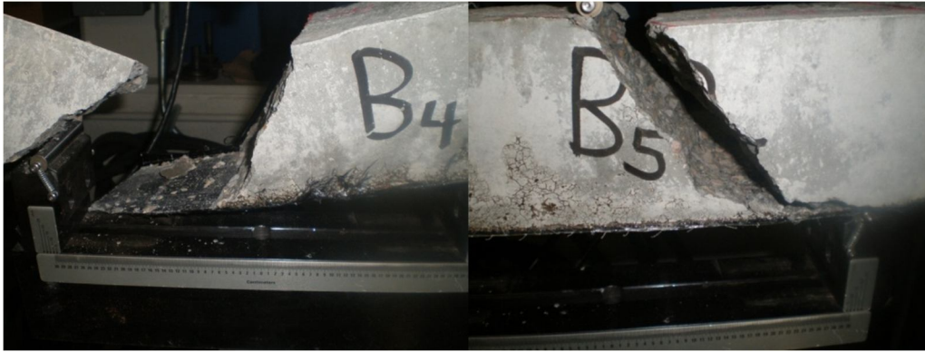
شكل (15) إنهيار القص مع إنفصال ألياف الكربون، B5, B4 Shear failure with CFRP delamination, B4, B5
