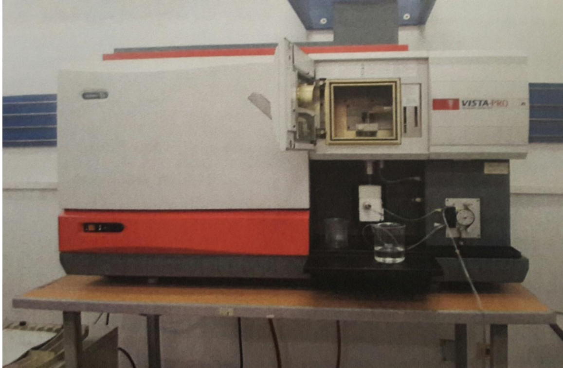
شكل (1) يوضح جهاز الحث الأزدواجي البلازمي ICP.
